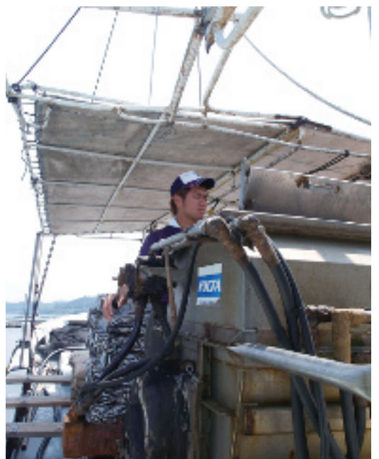
冷凍イワシと飼料を攪拌機で混ぜてエサをつくる
