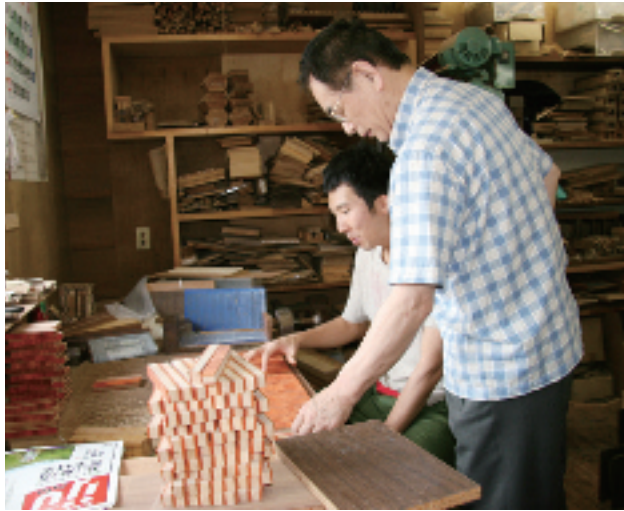
金指社長(右)に「ネリ」の作業を教わる清水さん(左)。積まれた木片(写真手前)が接着剤で重ねる前のパーツ
