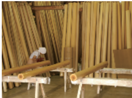
スギに防腐剤を塗っている様子。加工センターには出荷前の丸太が大量に保管されている
