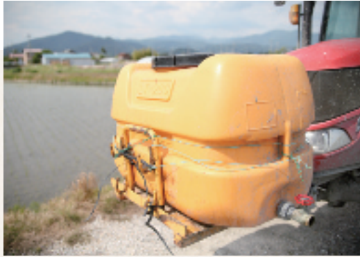
トラクターの先端に括り付けてあるのは、EM菌を自動で撒くための自作装置。
