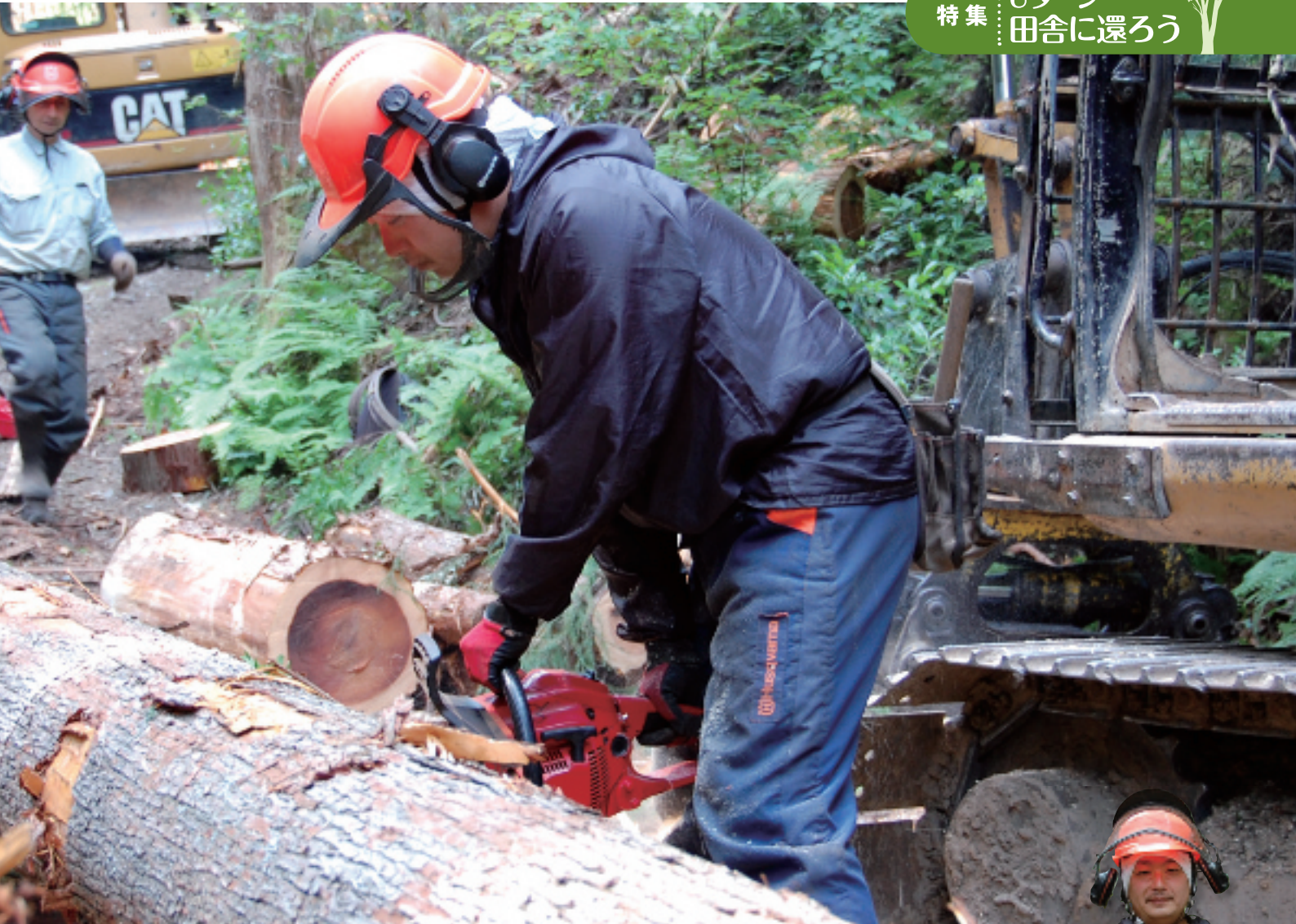
山の斜面から運び出された木々は、現場で玉切りして、その断面等から木材として使用できるか否かを確認する。
