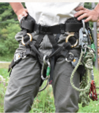
↑サドルと呼ばれる安全帯にロープやカラビナ、チェーンソーを取り付けて木に登る。アポリカルチャーならではの道具。
